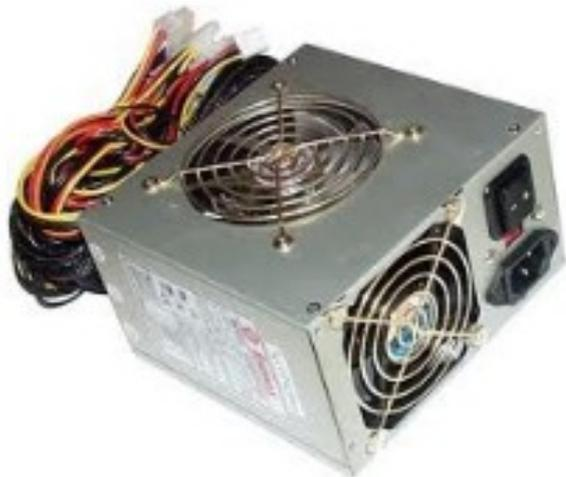
**Fonte de Alimentação:** É o módulo que fornece energia elétrica ao micro. As fontes de alimentação utilizadas hoje em dia são do tipo chaveada ( aumenta o rendimento e torna a fonte mais compacta ).
