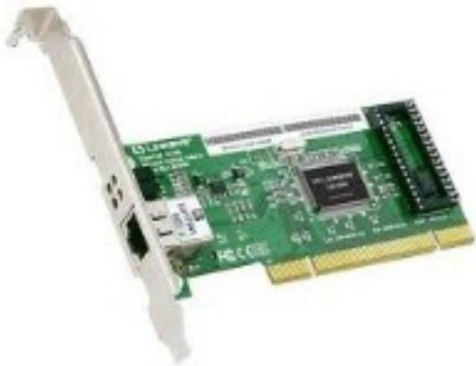
**Placa de Rede:** É um dispositivo de entrada e saída de dados e permite a comunicação através da estrutura de cabeamentos. É também conhecida como: Adaptador de rede, NIC ( Placa de Interface de Rede ) ou Placa Ethernet ( por causa da arquitetura usada).
