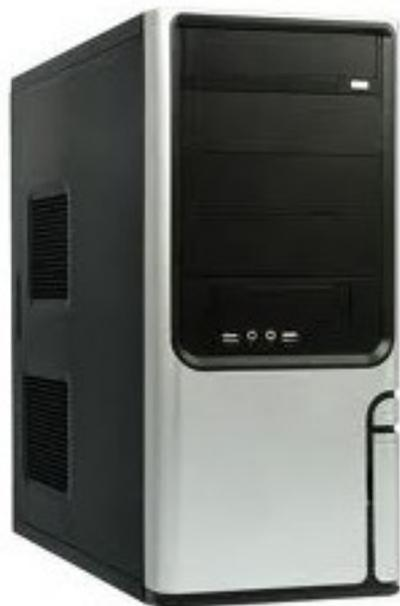
**Gabinete:** É a estrutura onde são montados todos os componentes do micro: Fonte, placa-mãe, drivers, disco rígido, CD-ROM, etc. Geralmente o gabinete é confundido com a CPU- Central Processing Unit (Unidade central de processamento, em português); CPU é apenas o Processador e no gabinete ficam guardados os componentes internos do micro que serão o próximo assunto a abordarmos.
