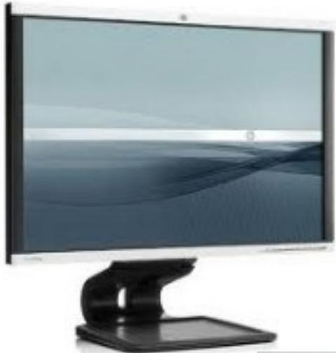
**Monitor:** É o mais importante dispositivo de entrada e saída de dados do PC. Ele dá a você a situação imediata do que está acontecendo no computador. A informação que necessita ser apresentada visualmente é enviada ao monitor através da placa de vídeo que converte os sinais elétricos da CPU para minúsculos pontos de cor chamados: Pixels, eles formam a imagem na tela.
